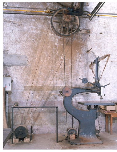
Vue d'ensemble depuis l'ouest, avec le moteur électrique et son système d'entraînement. Phot. Yves Sancey IVR43_20022500757XA
