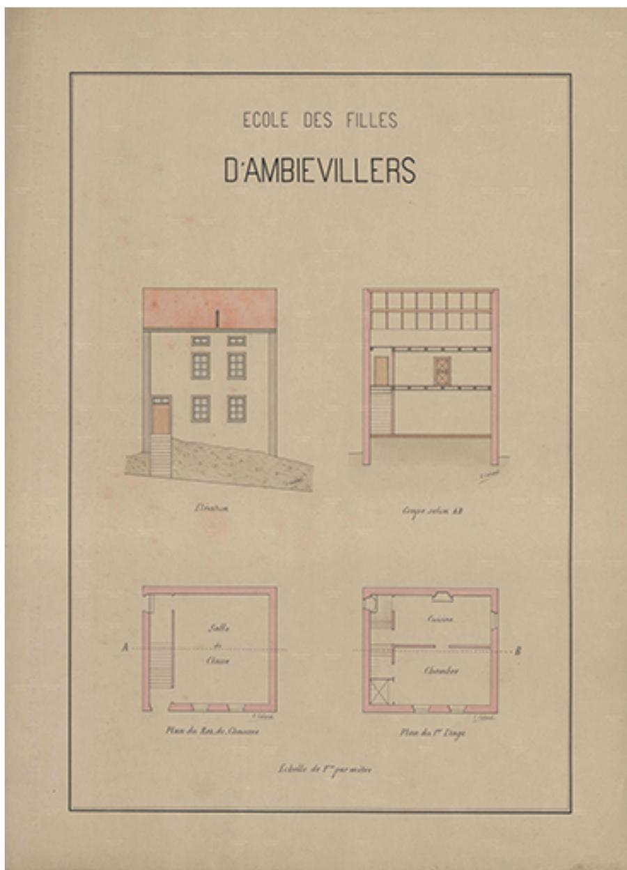
Plan de l'école des filles : élévation, coupe, rez-de-chaussée et 1er étage.
