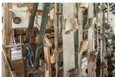
Détail des élévateurs à godets. Phot. Jérôme Mongreville IVR43_20142501168NUC4A
