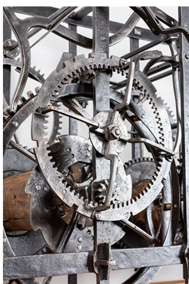
Détail de l'horloge publique : la roue de compte. Phot. Sonia Dourlot IVR43_20193900072NUC4A
