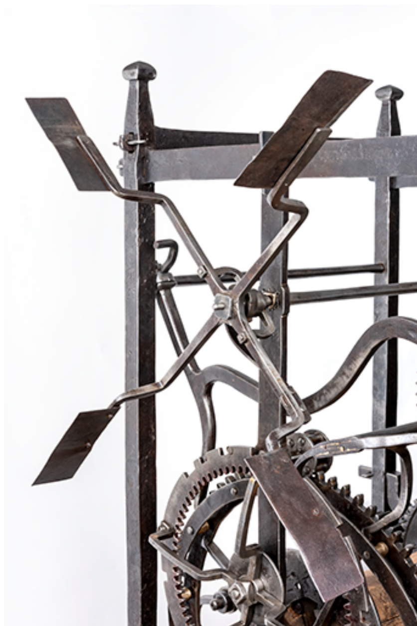
Détail de l'horloge publique : le volant régulateur de sonnerie.
