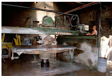
2e débiteur Gregori en cours de sciage, avec ouvrier. Phot. Yves Sancey IVR43_19973901724ZA
