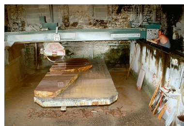
Débiteur Gregori en cours de sciage : vue d'ensemble. Phot. Yves Sancey IVR43_19973901732ZA
