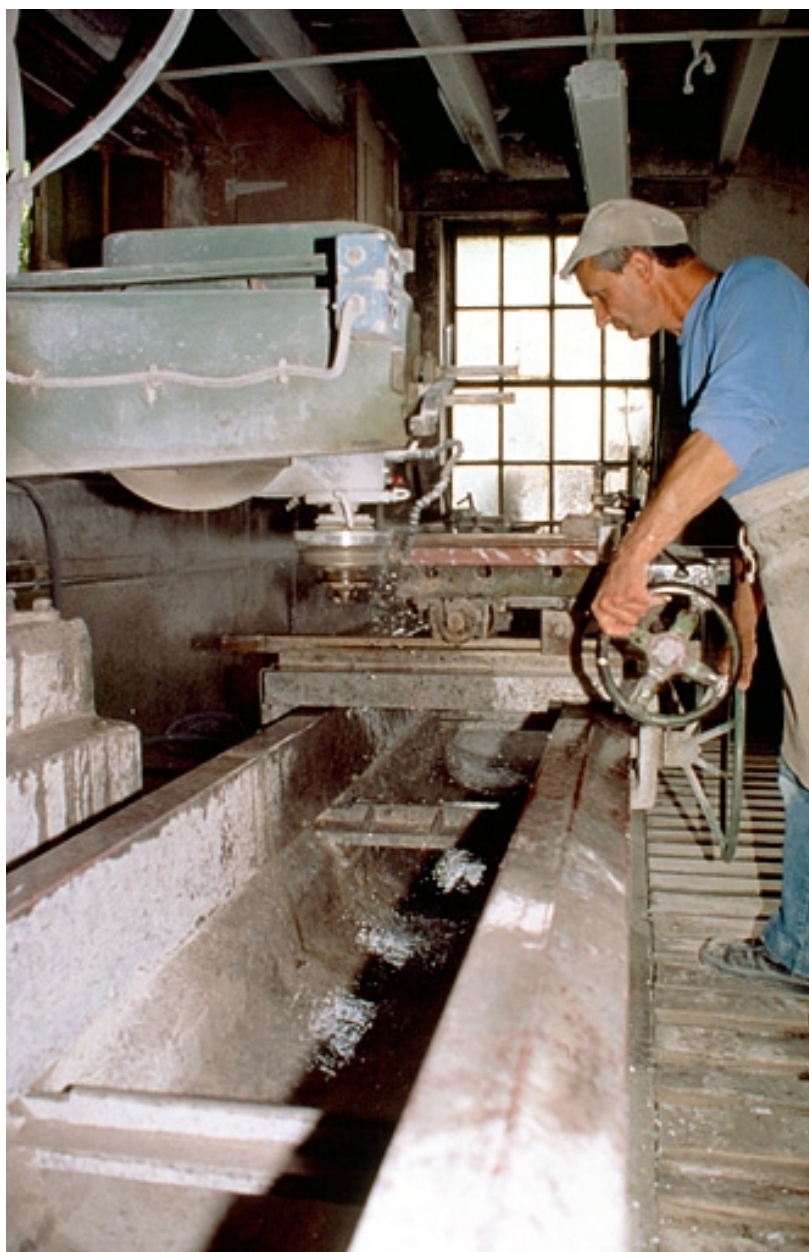
Moulurage d'une plaque de marbre.
