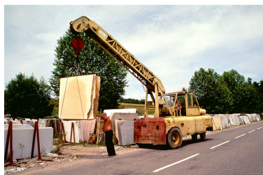
Transport de tranches de marbre avec la grue automotrice Belotti. Phot. Yves Sancey IVR43_19973901710ZA
