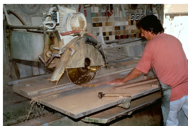
Débitage de plinthes en marbre de Balanod. Phot. Yves Sancey IVR43_19973901738ZA
