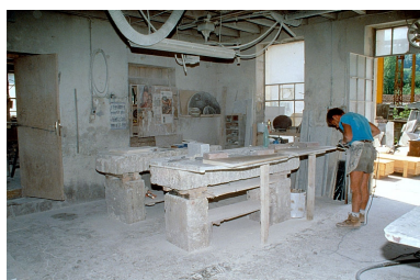
Polissage du chant d'une marche d'escalier à l'aide d'une meuleuse. Phot. Yves Sancey IVR43_19973901757ZA
