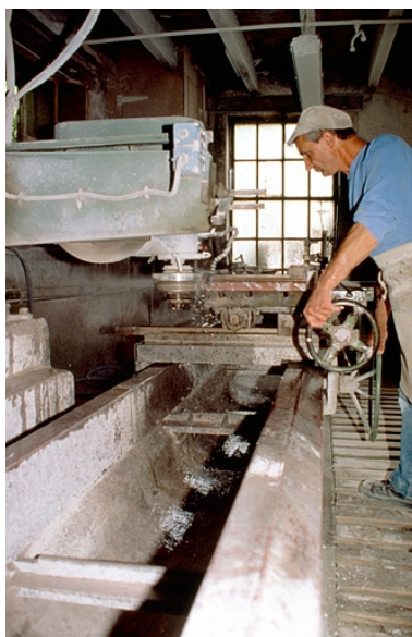
Moulurage d'une plaque de marbre. Phot. Yves Sancey IVR43_19973901741ZA
