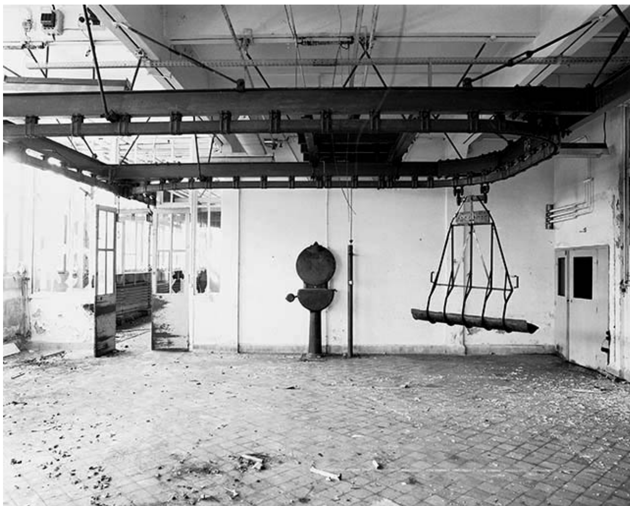
Bascule du monorail et chariot suspendu.
