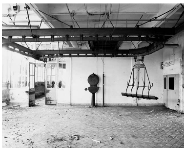
Bascule du monorail et chariot suspendu. Phot. Yves Sancey IVR43_19932500029X
