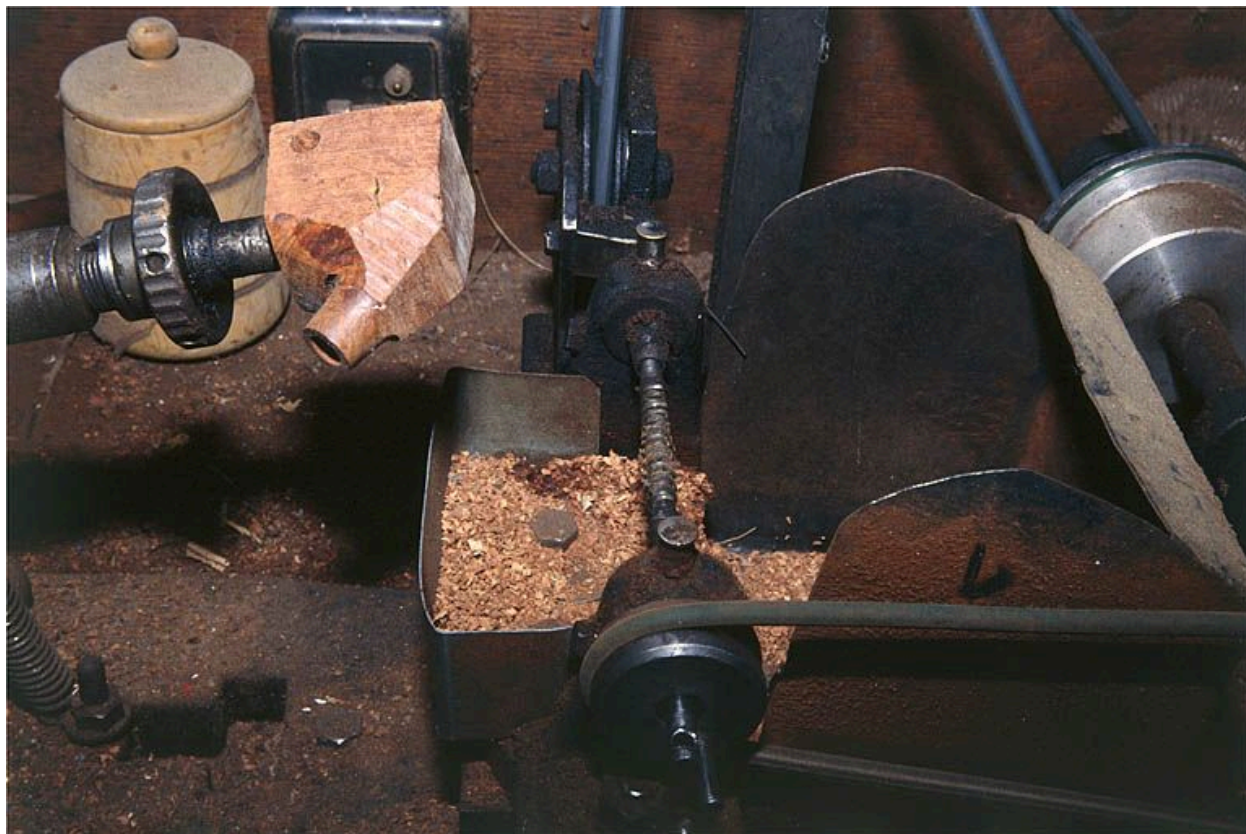
Partie gauche : détail du support de l'ébauchon. A droite, arbre cranté horizontal faisant office de fraise.
