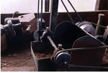
Vue d'ensemble de la partie droite : arbre cranté horizontal faisant office de fraise. Phot. Jérôme Mongreville IVR43_20003901022ZA
