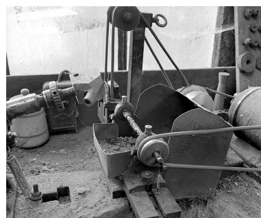
Vue d'ensemble de la partie droite : arbre cranté horizontal faisant office de fraise. Phot. Jérôme Mongreville IVR43_20003901021X
