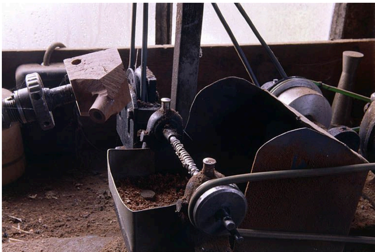
Vue d'ensemble de la partie droite : arbre cranté horizontal faisant office de fraise.
