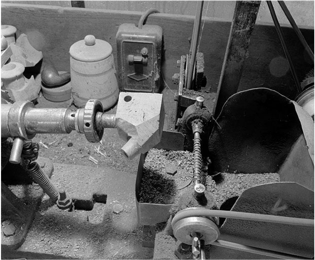
Partie gauche : détail du support de l'ébauchon. A droite, arbre cranté horizontal faisant office de fraise.
