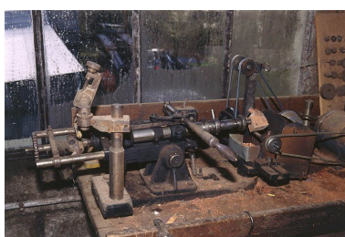
Vue d'ensemble de la partie gauche : guide et support de l'ébauchon. Phot. Jérôme Mongreville IVR43_20003901026ZA
