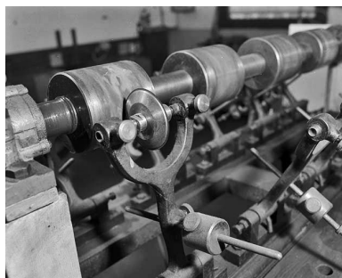
Emplacement de diamantage, avec molette en place. Phot. Jérôme Mongreville IVR43_20013900040X
