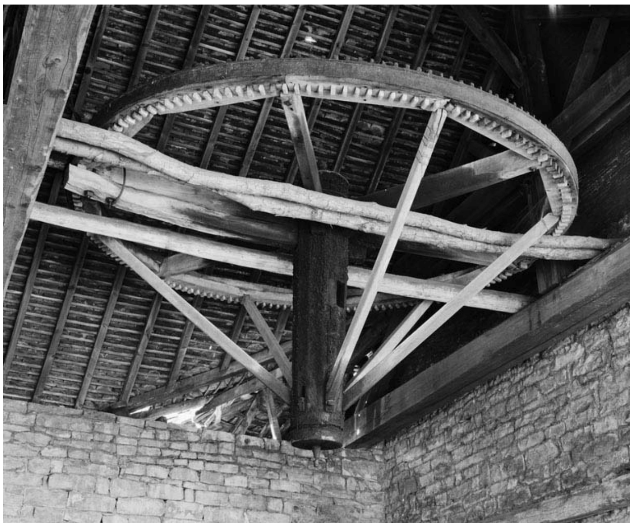
Détail de la roue servant à malaxer la terre glaise.
