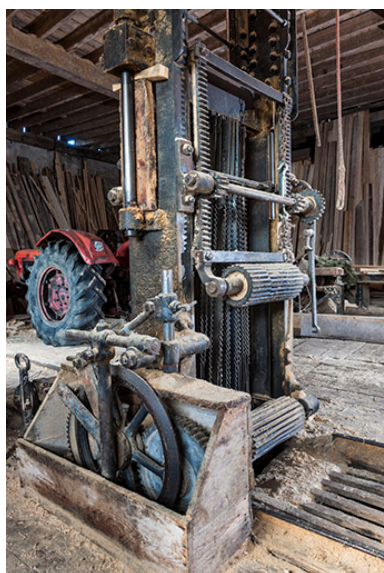
Châssis de scie vu de trois quarts. Au premier plan : système d'entraînement. Phot. Jérôme Mongreville IVR43_20152501803NUC4A
