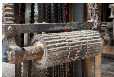
Châssis de scie. Détail d'un cylindre d'avancée de la grume. Phot. Jérôme Mongreville IVR43_20152501804NUC4A
