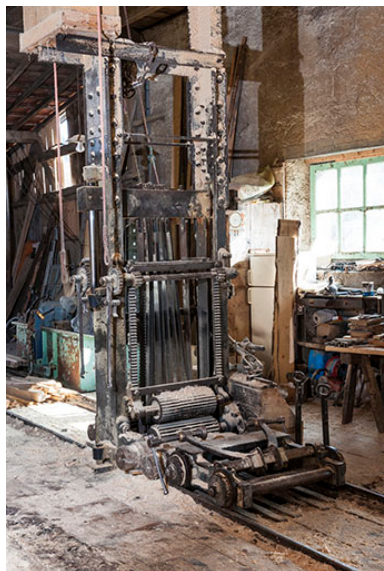
Châssis de scie et son chariot. Phot. Jérôme Mongreville IVR43_20152501810NUC4A
