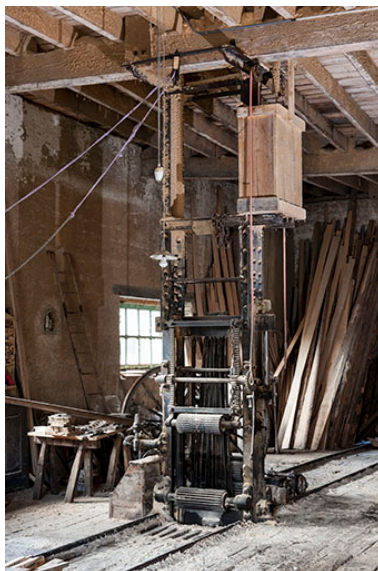
Châssis de scie multilames. Phot. Jérôme Mongreville IVR43_20152501801NUC4A
