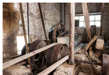
Etage de soubassement. Axe de transmission de la turbine et poulies de renvoi. Phot. Jérôme Mongreville IVR43_20152501805NUC4A
