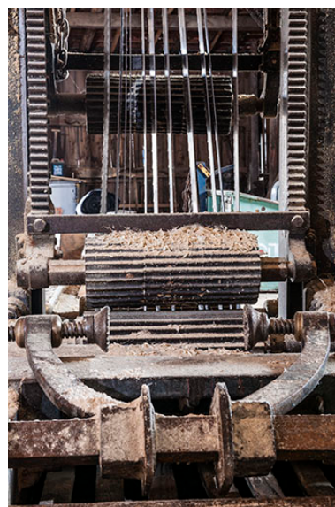
Détail du chariot et du châssis de scie. Phot. Jérôme Mongreville IVR43_20152501812NUC4A
