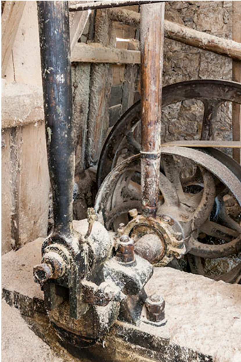
Bielle de transmission de l'axe secondaire (étage de soubassement) au châssis de scie.
