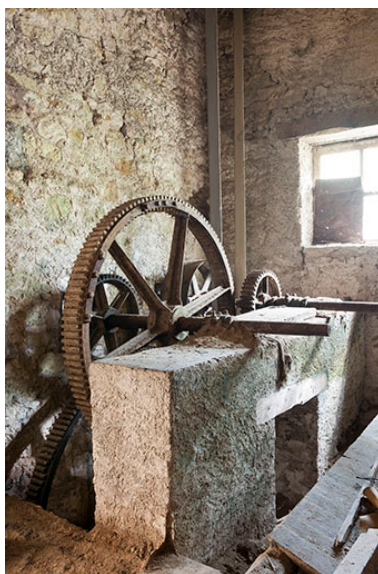
Système de transmission annexe par engrenages (scie circulaire ?). Phot. Jérôme Mongreville IVR43_20152501807NUC4A
