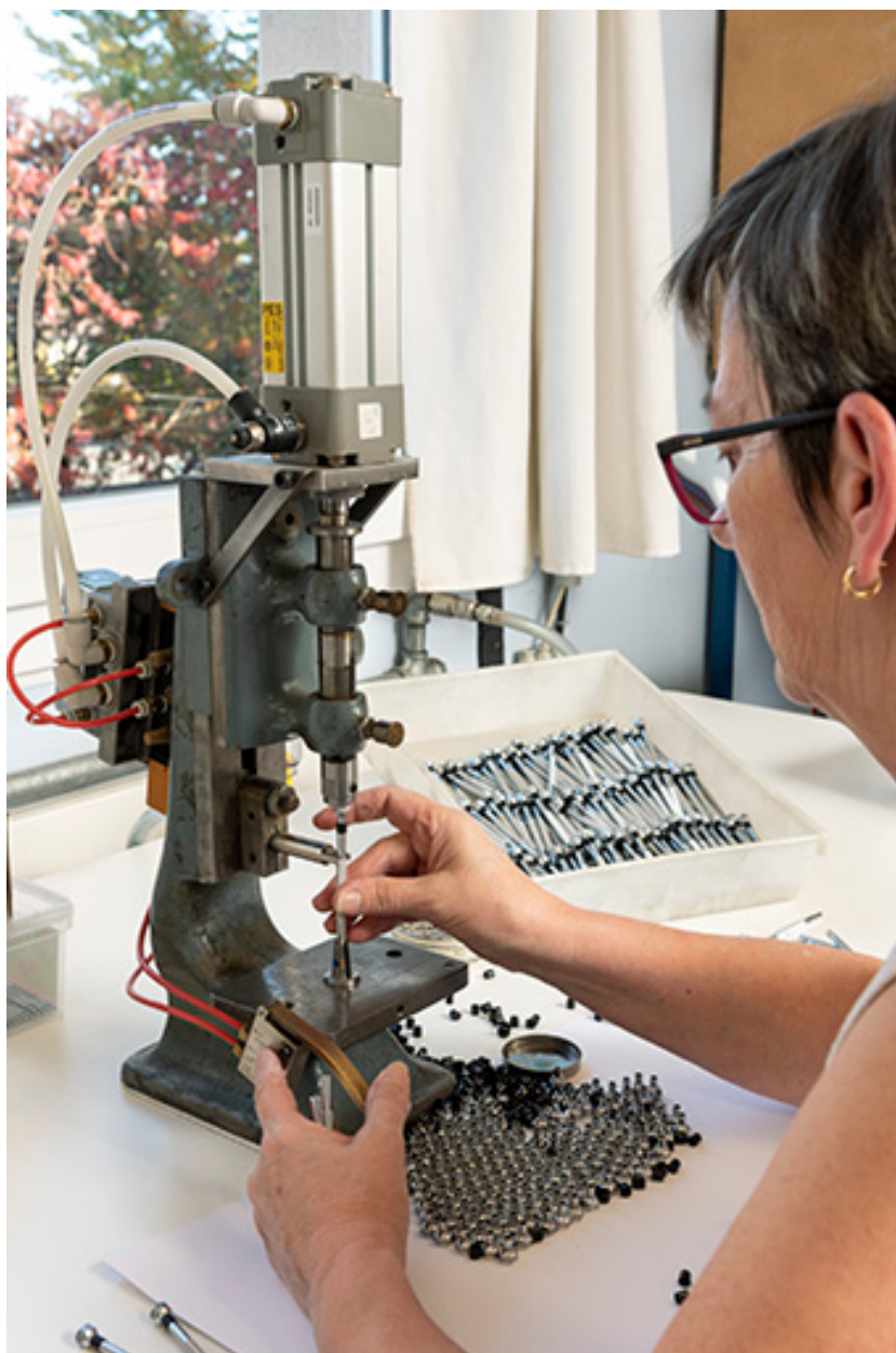
Atelier de fabrication sud : ouvrière assemblant un tournevis.
