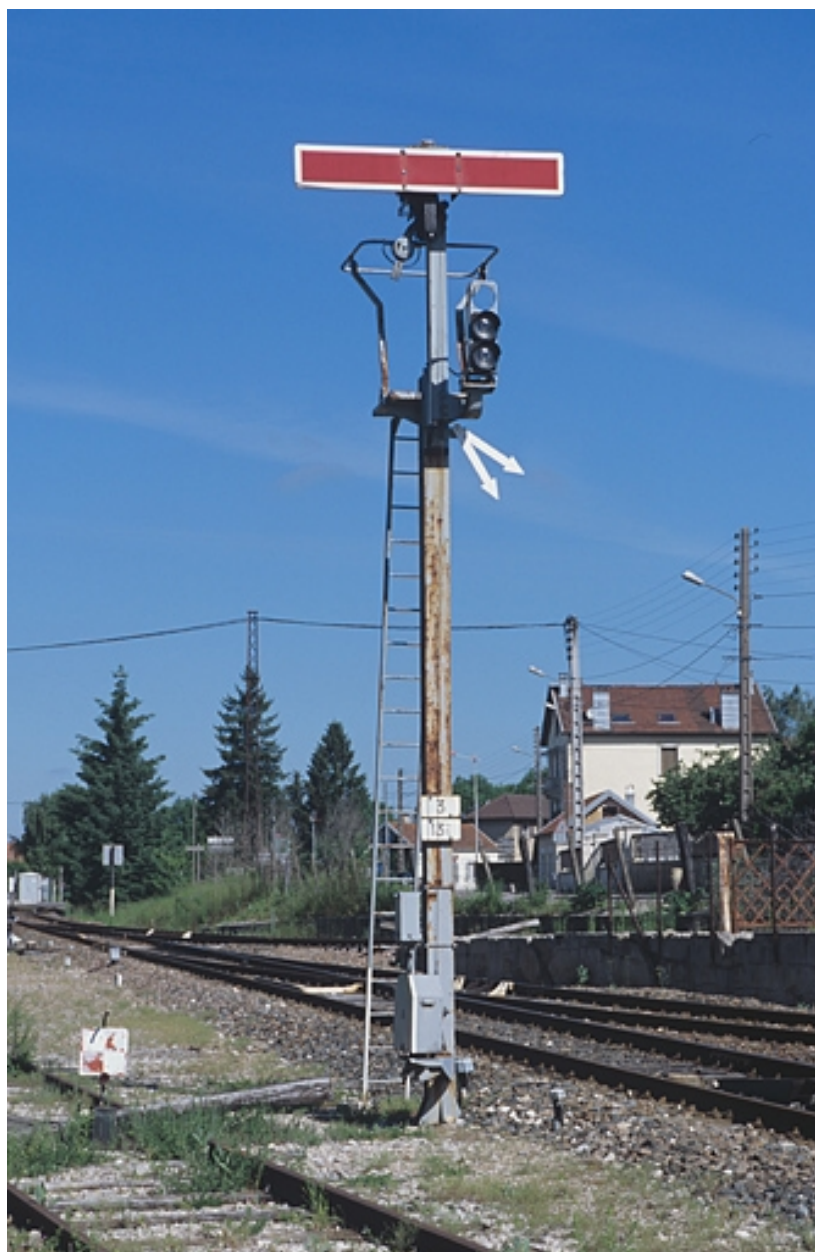
Sémaphore côté Andelot-en-Montagne : vue d'ensemble, en position fermée.
