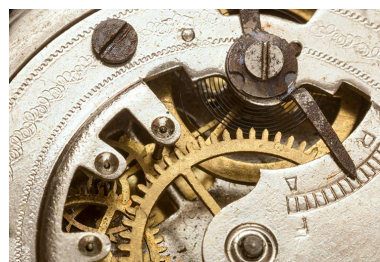
Mouvement : détail, avec la roue d'ancre à l'arrière-plan à gauche. Phot. Sonia Dourlot IVR43_20162500721NUC4A
