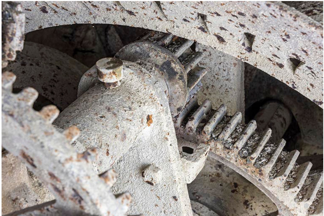
Usine : pignon entraînant le secteur commandant l'admission d'eau dans la turbine.
