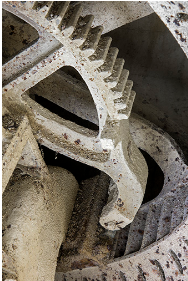
Usine : secteur commandant l'admission d'eau dans la turbine. Phot. Sonia Dourlot IVR43_20172500032NUC4A
