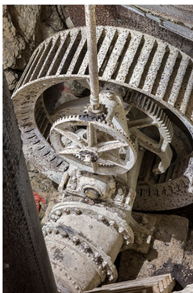
Usine : turbine Laurioz, au 2e étage de soubassement (chambre d'eau). Actionné depuis le rez- de-chaussée, l'arbre vertical commande l'admission d'eau. Phot. Sonia Dourlot IVR43_20172500031NUC4A
