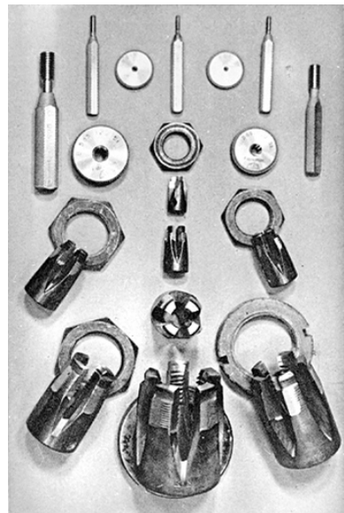
Pièces fabriquées : filières et jauges. Phot. Yves Sancey IVR43_20009000874X
