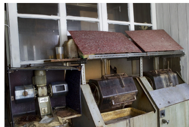
Vue d'ensemble des tonneaux Uron. Phot. Yves Sancey IVR43_20103900315NUC2A
