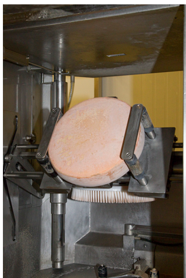
Fabrication du morbier : retournement d'une meule (robot). Phot. Yves Sancey IVR43_20132500361NUC2A
