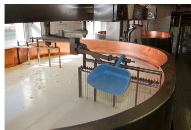
Fabrication du comté : deuxième cuve, avec tranche-caillé et pelle.
