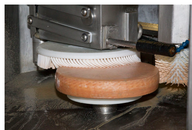
Fabrication du morbier : salage et brossage d'une meule (robot). Phot. Yves Sancey IVR43_20132500359NUC2A
