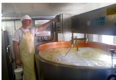
Fabrication du comté : réglage à la première cuve.
