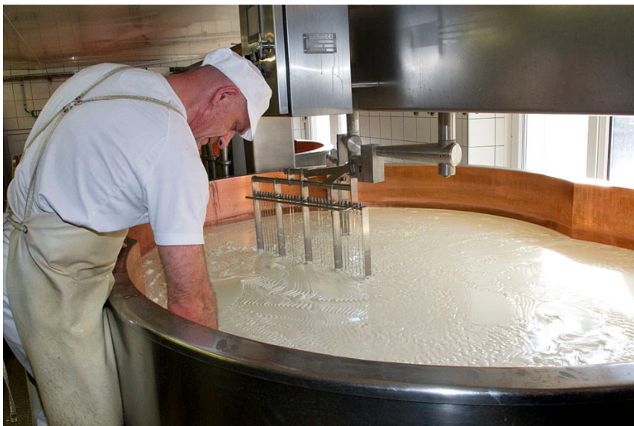
Fabrication du comté : examen du tranchage du caillé dans la deuxième cuve.
