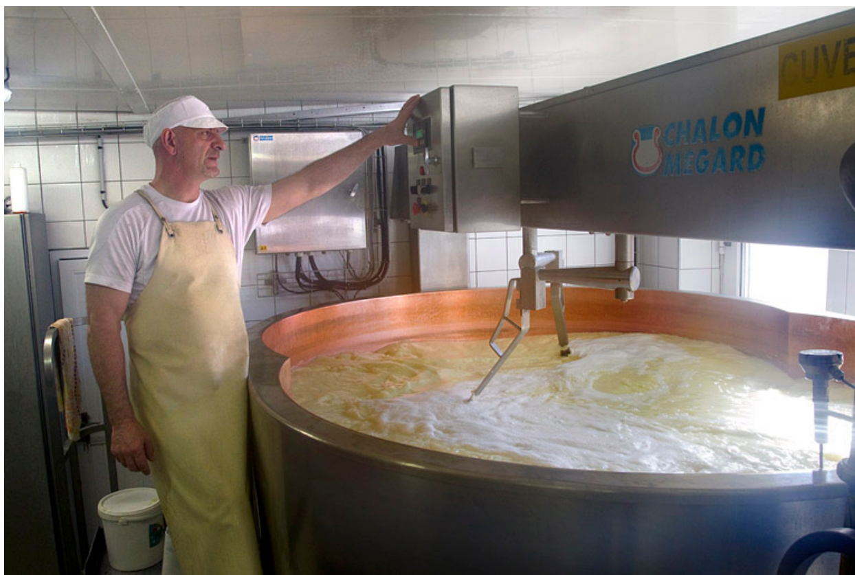
Fabrication du comté : réglage à la première cuve.
