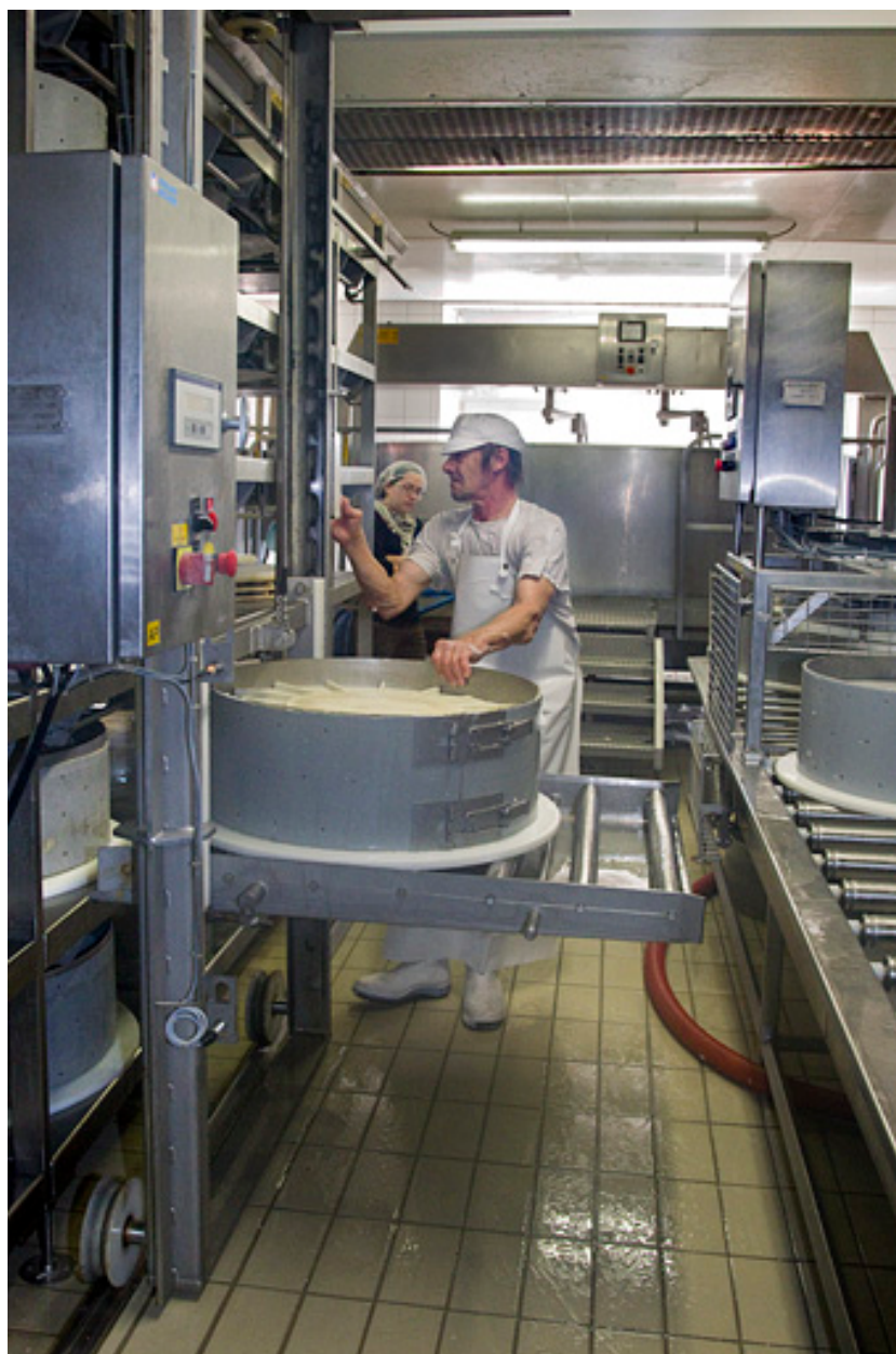
Fabrication du comté : mise sous presse du moule rempli de caillé.
