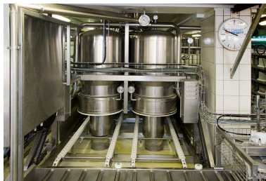
Fabrication du comté : installation de soutirage (face avant).
