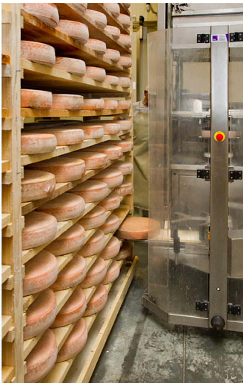
Fabrication du morbier : robot prenant une meule.
