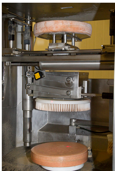
Fabrication du morbier : zone de travail du robot de soins, avec deux meules en place. Phot. Yves Sancey IVR43_20132500360NUC2A
