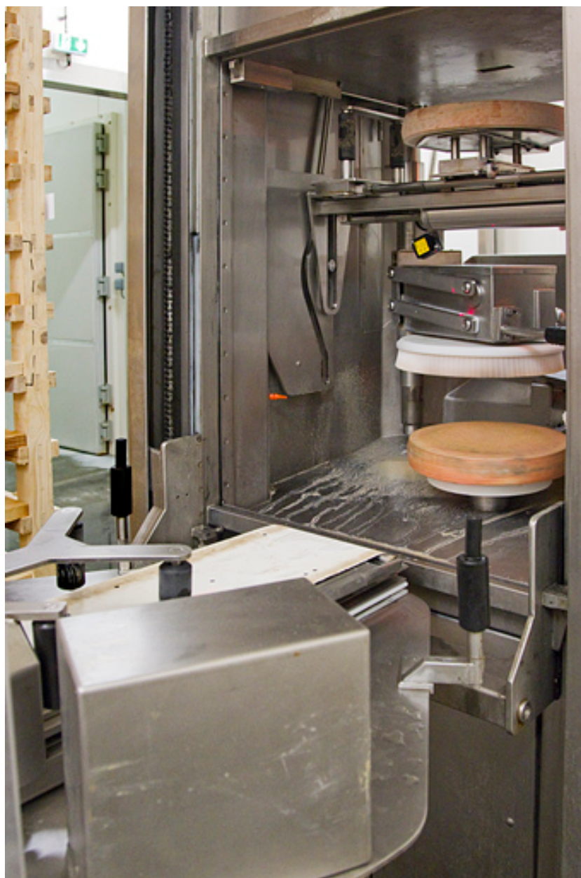
Fabrication du morbier : zone de travail du robot de soins.
