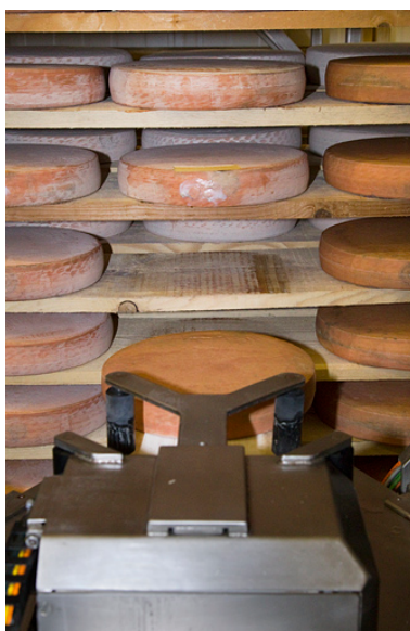
Fabrication du morbier : système de préhension des meules (robot). Phot. Yves Sancey IVR43_20132500358NUC2A
