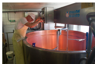
Fabrication du comté : nettoyage de la première cuve (réglage des brosses)
