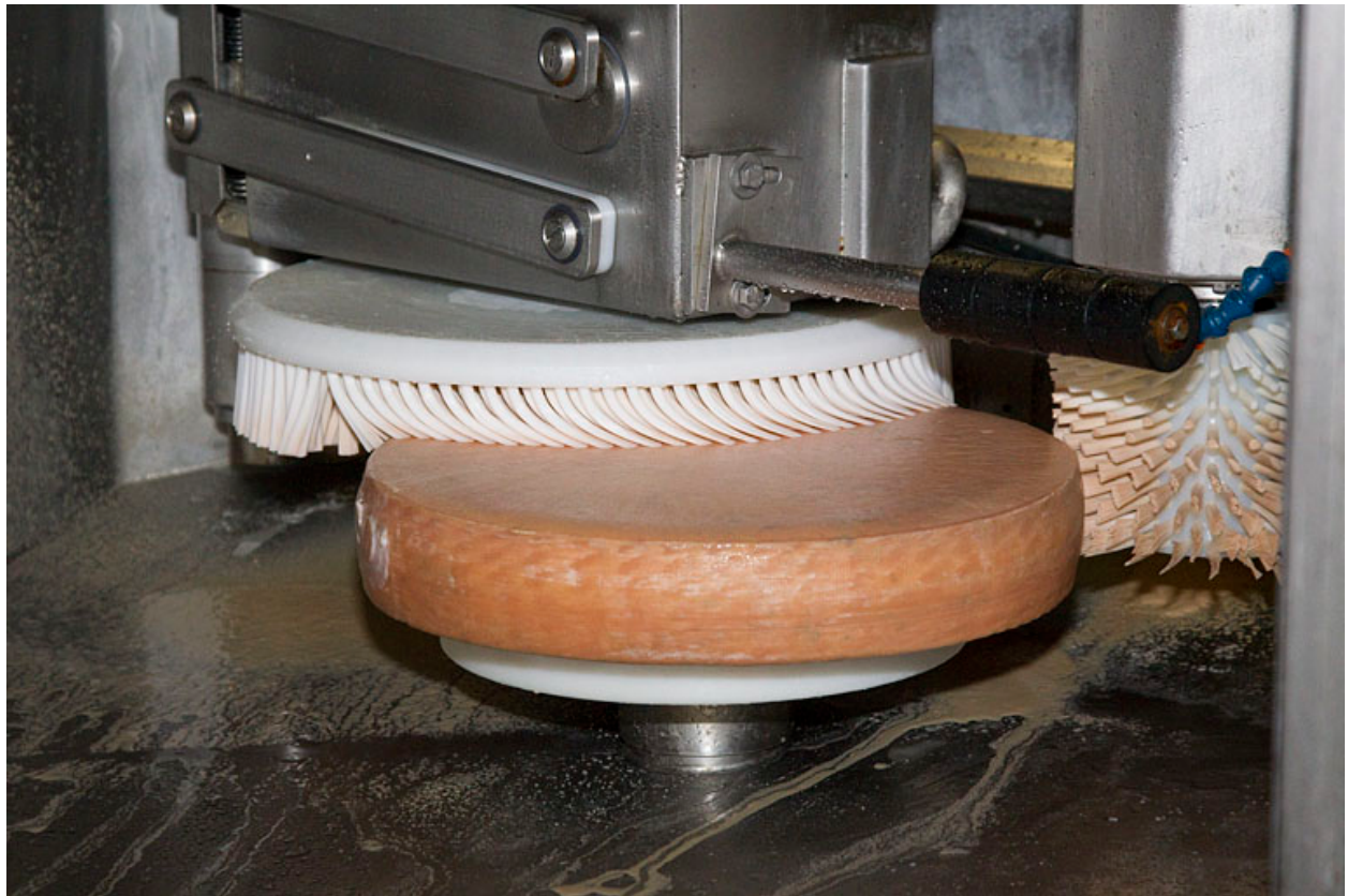
Fabrication du morbier : salage et brossage d'une meule (robot).
