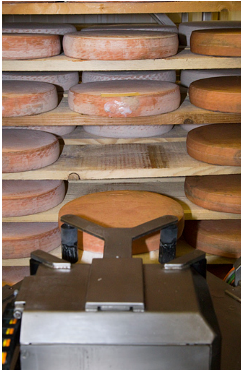
Fabrication du morbier : système de préhension des meules (robot).
