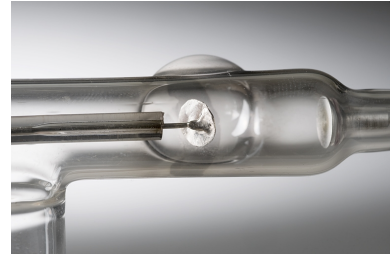
Détail : anode et cathode. Phot. Marc Loukachine IVR43_20122500096NUC4A
