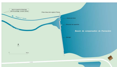
Carte schématique du bassin de compensation et de la prise d'eau de la rigole d'Yonne. Dess. Alain Morelière IVR26_20145800014NUDA
