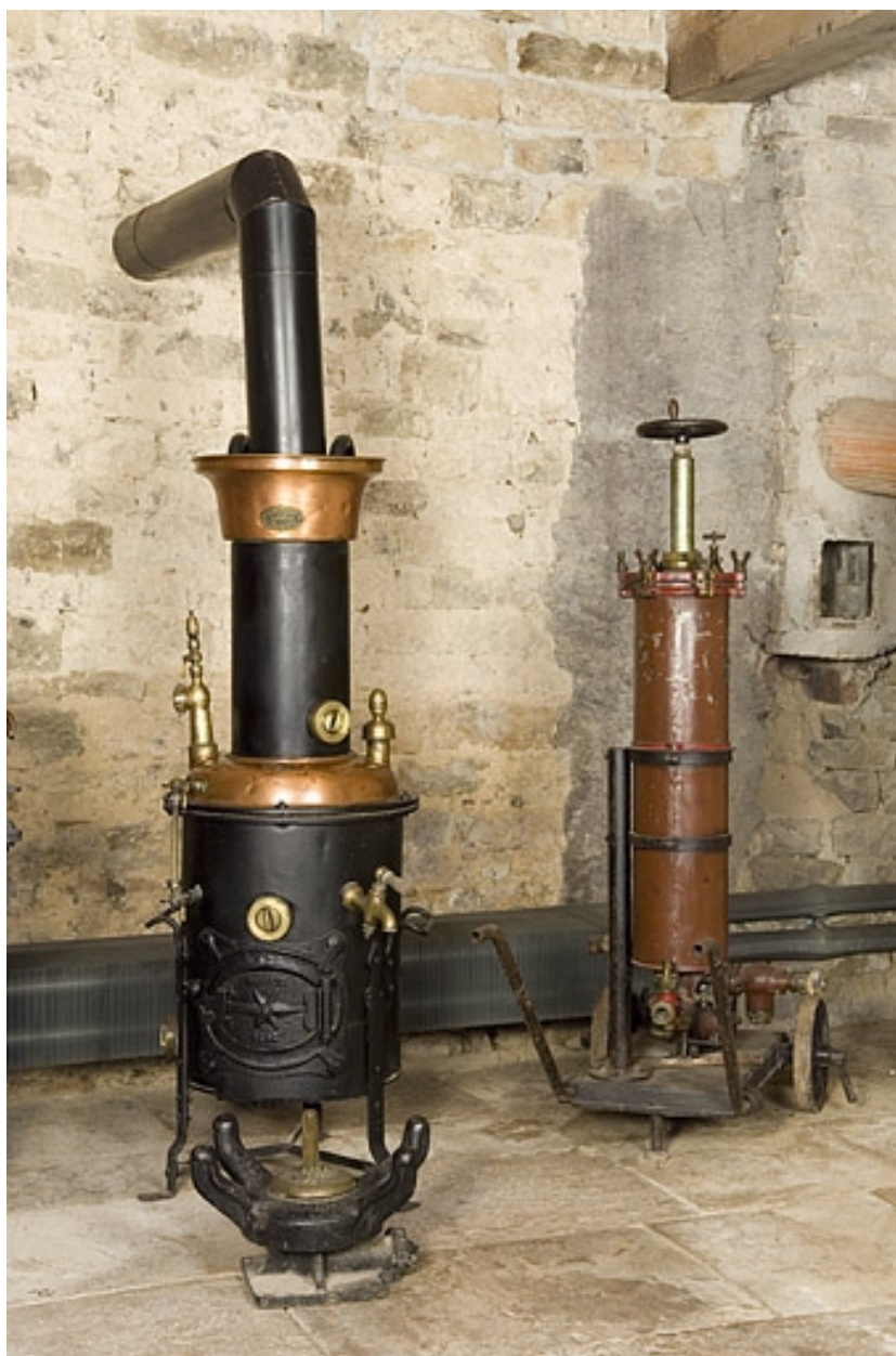
Chaudière des Ets Chatillon (pour l'entretien des tonneaux de fermentation) et filtreuse Simoneton.
