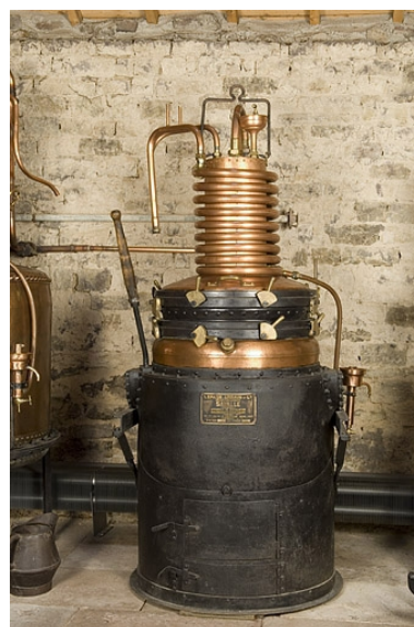
Alambic à vapeur Lepage, Urbain et Cie, provenant de la distillerie Lemer cier (Prédurupt). Phot. Jérôme Mongreville IVR43_20067000810NUCA
