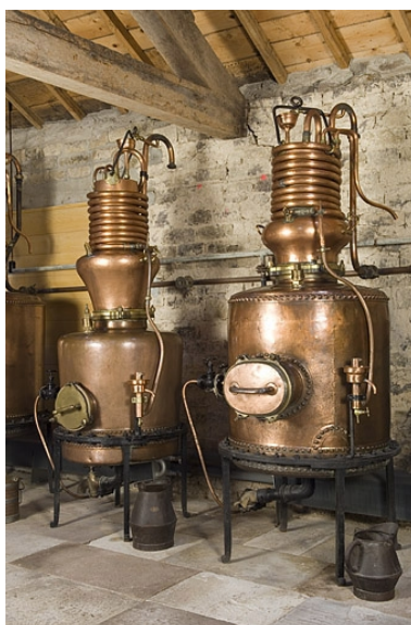
Deux alambics à vapeur provenant de la distillerie Lemer cier (Prédurupt). Phot. Jérôme Mongreville IVR43_20067000816NUCA
