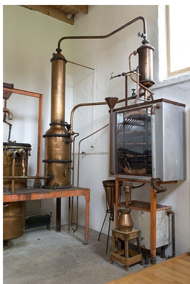
Salle de distillation. Colonne de rectification et réfrigérant. Phot. Jérôme Mongreville IVR43_20067000800NUCA
