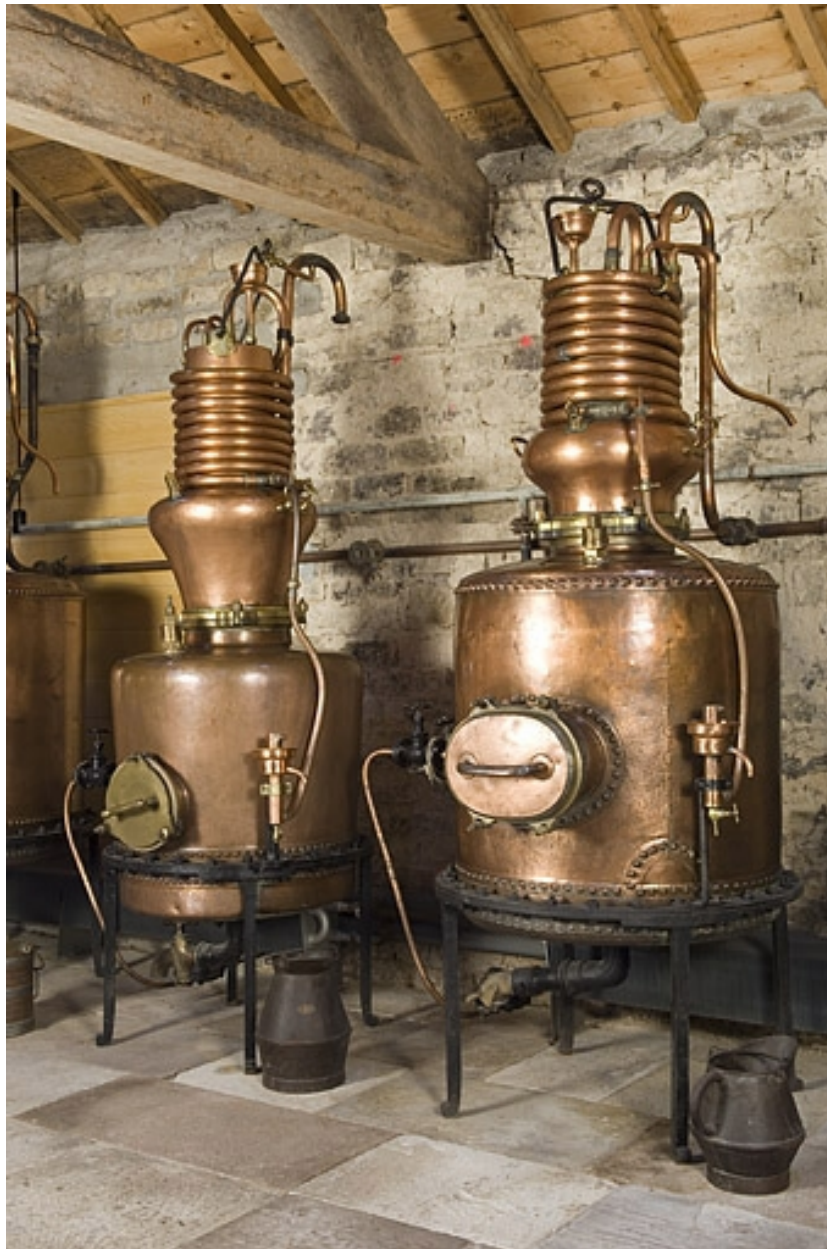
Deux alambics à vapeur provenant de la distillerie Lemer cier (Prédurupt).
