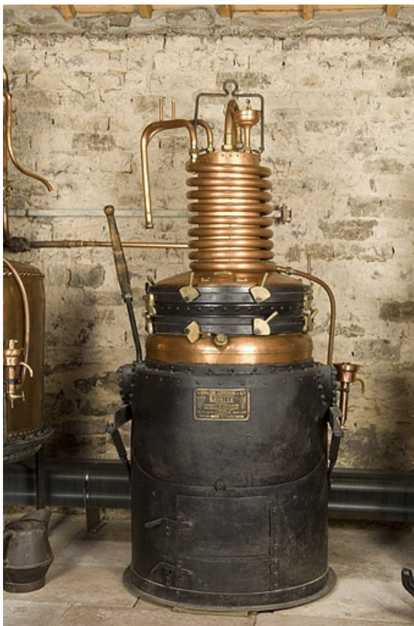
Alambic à vapeur Lepage, Urbain et Cie, provenant de la distillerie Lemerrier (Prédurupt).
