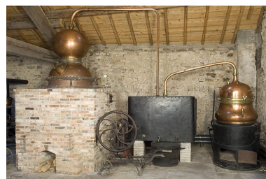
Alambics, chaudières et réfrigérant (au centre). Phot. Jérôme Mongreville IVR43_20067000804NUCA
