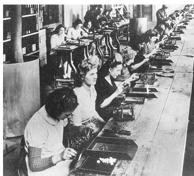
Atelier de forgeage et de brasage des hameçons triples. Phot. Jérôme Mongreville IVR43_20029000040X
