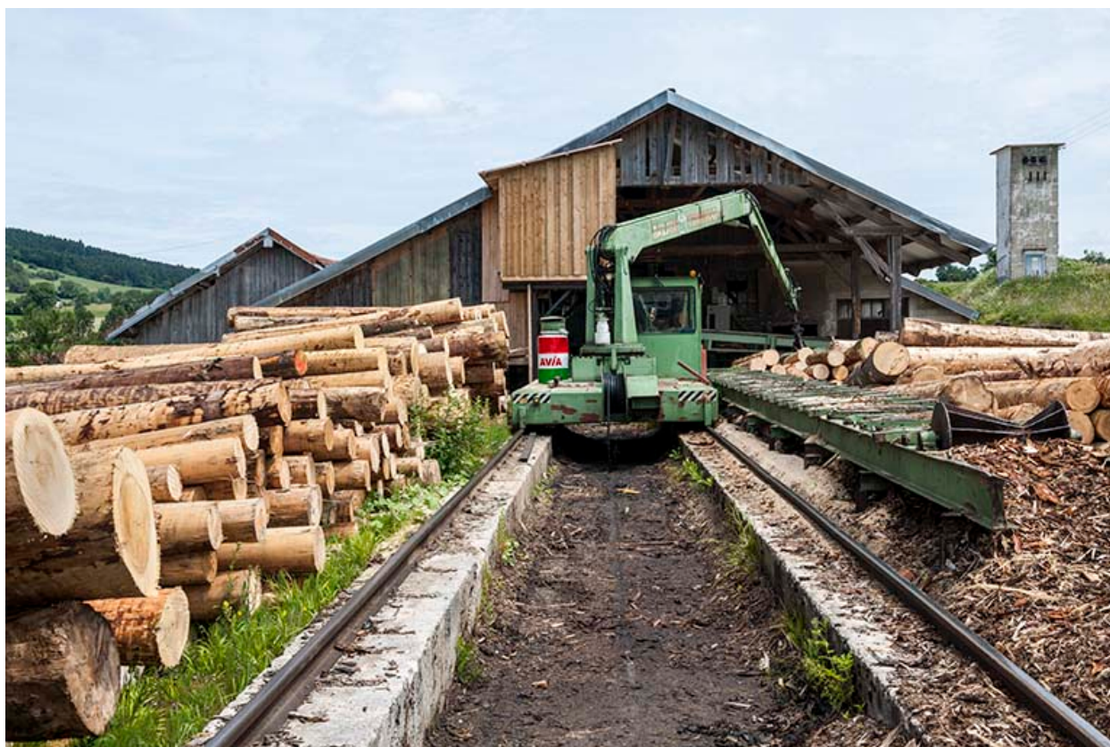
Chariot de transport de grumes, sur rails.
