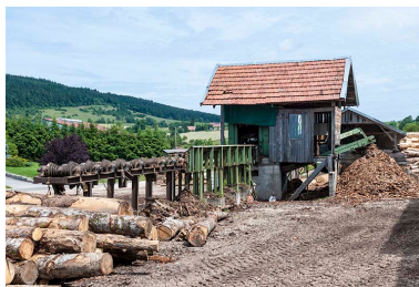
Poste d'écorçage. Phot. Jérôme Mongreville IVR43_20152501473NUC4A
