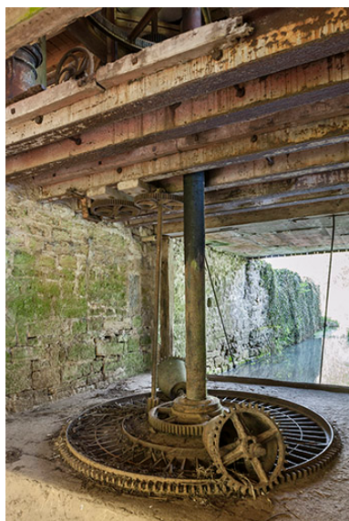
Partie supérieure de la turbine. Phot. Jérôme Mongreville IVR43_20152501165NUC4A
