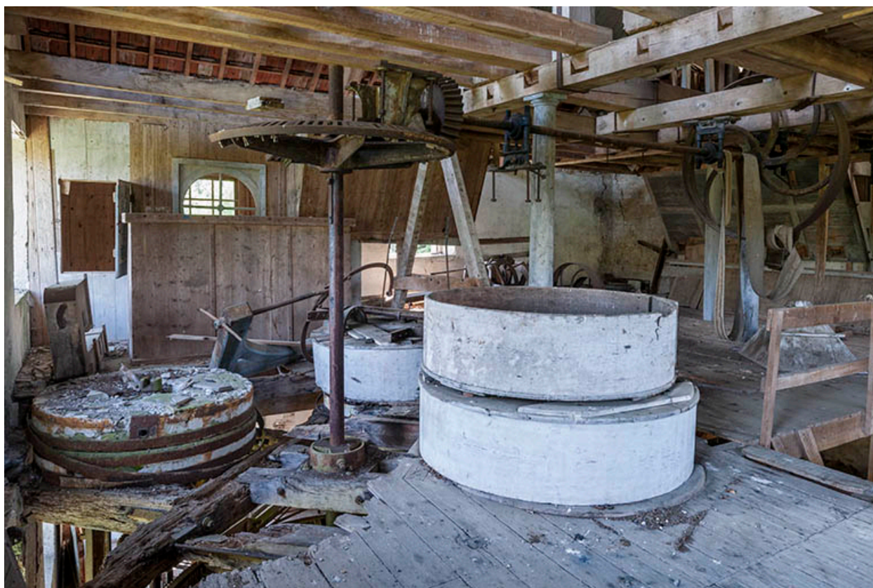
Premier étage. Les meules, leur archure, et les éléments de transmission pour l'étage supérieur.
