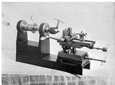
Exemple de machine à percer du
