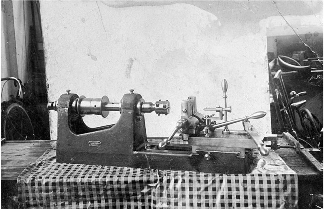
Exemple de machine à floquer du constructeur mécanicien Lizon.
