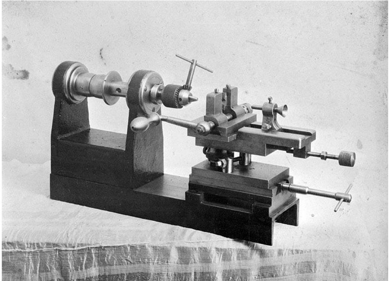
Exemple de machine à percer du constructeur mécanicien Lizon.
