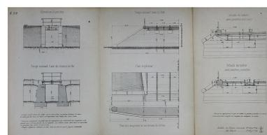
Pont sous rails à tablier métallique de 1 m 50 d'ouverture. Type de la Compagnie de Paris - Lyon - Méditerranée. E 29 [plan, coupes, élévation et détails], 1879. Phot. Yves Sancey
