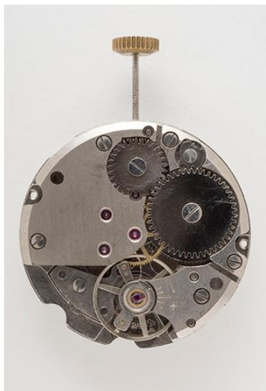
Mouvement FE 140-2A, vu côté pont.
