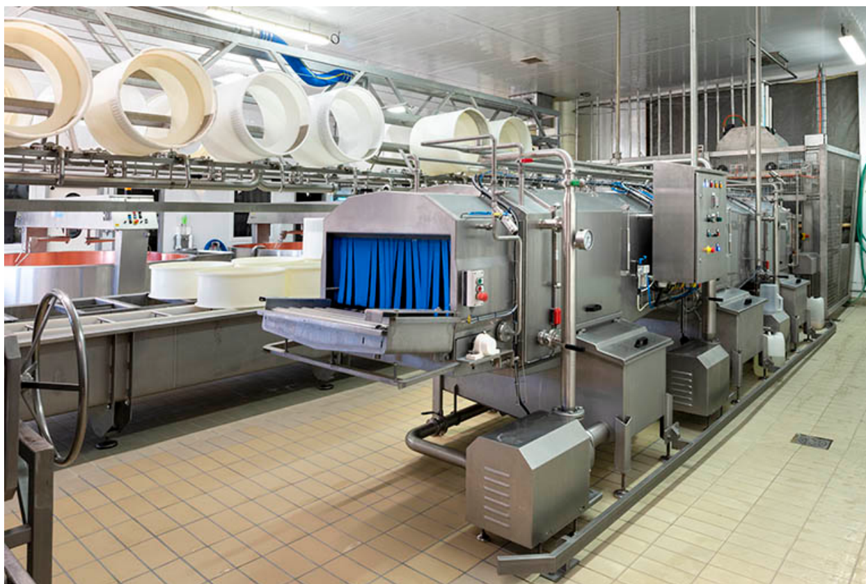
Atelier de fabrication : tunnel de lavage des moules.
