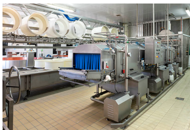
Atelier de fabrication : tunnel de lavage des moules. Phot. Sonia Dourlot IVR43_20182501703NUC4A
