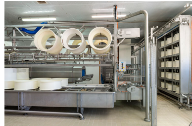
Atelier de fabrication : installations de soutirage et moulage à gauche, de pressage à droite. Phot. Sonia Dourlot IVR43_20182501701NUC4A
