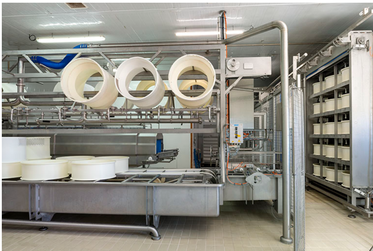
Atelier de fabrication : installations de soutirage et moulage à gauche, de pressage à droite.
