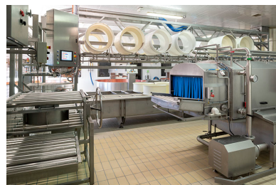
Atelier de fabrication : système de transfert des moules à gauche (avec le tableau de commande du pressage), extrémité du tunnel de lavage à droite. Phot. Sonia Dourlot IVR43_20182501704NUC4A
