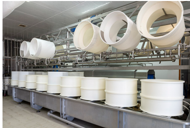
Atelier de fabrication : installation de soutirage et moulage. Phot. Sonia Dourlot IVR43_20182501700NUC4A
