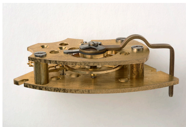
Echappement à chevilles et porte-échappement de la société Jeambrun Appareillages. Phot. Sonia Dourlot IVR43_20152502582NUC4A
