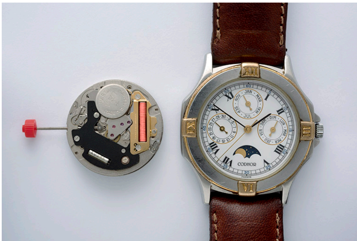
Montre-bracelet à quartz Codhor (mouvement FE 11500).
