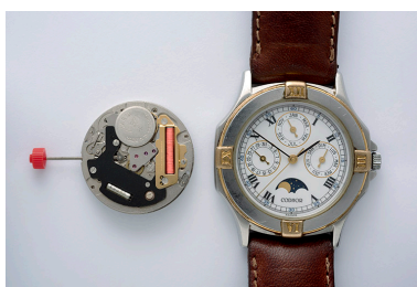
Montre-bracelet à quartz Codhor (mouvement FE 11500). Phot. Sonia Dourlot IVR43_20152502598NUC4A
