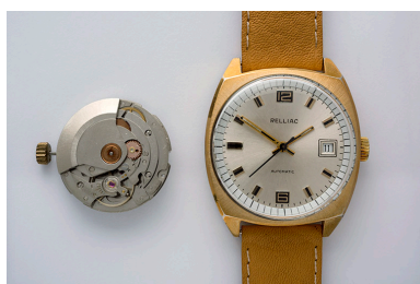
Montre-bracelet automatique Relliac, à côté d'un mouvement FE 4611. Phot. Sonia Dourlot IVR43_20152502620NUC4A
