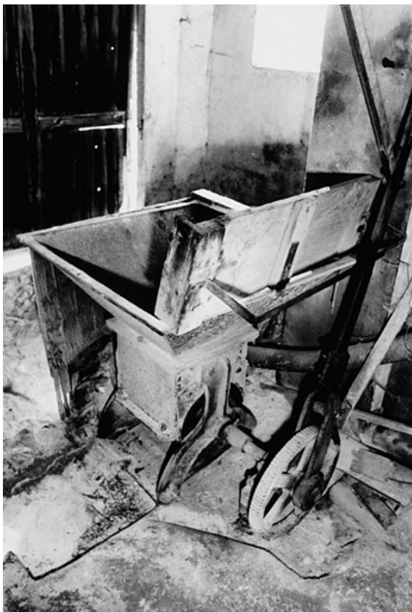
Doseur de sable, vu en plongée.
