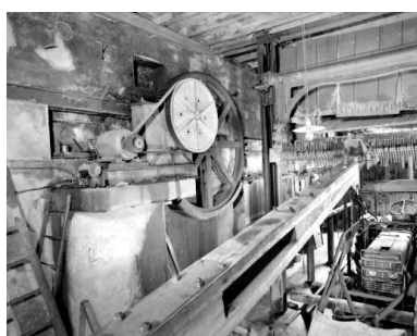
Noria : moteur et système d'entraînement. Phot. Yves Sancey IVR43_19933900316X
