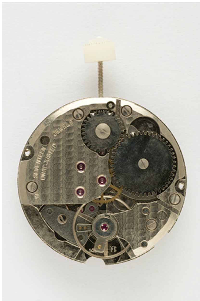
Mouvement France Ebauches FE 140-C : face côté ponts.
