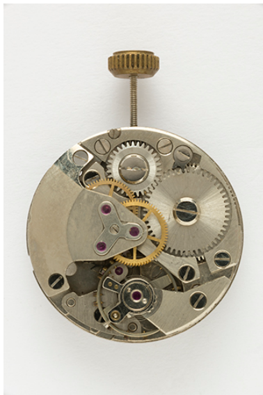
Mouvement Parrenin HP 90 : face côté ponts. Phot. Sonia Dourlot IVR43_20162500734NUC4A
