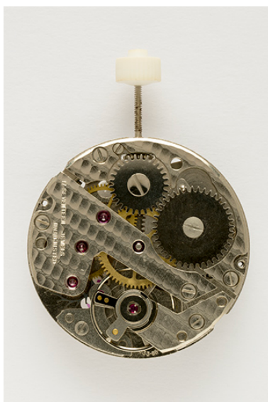
Mouvement France Ebauches 233-68-E-21 : face côté ponts. Phot. Sonia Dourlot IVR43_20162500757NUC4A
