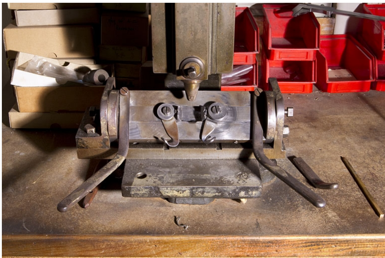
Système de fixation du nez et coulisseau.
