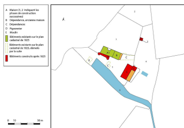
Plan de masse et de situation, présentant l'évolution des bâtiments. Extrait du plan cadastral, 2020, section B, échelle 1/5000. Dess. Pierre-Marie Barbe-Richaud IVR26_20207100142NUDA
