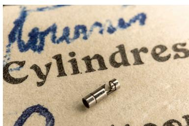
Cylindre. La lèvre d'entrée (la plus grande) est visible en avant-plan, celle de sortie (plus petite) à l'arrière-plan.
