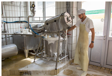
Nettoyage des installations : filtre à sérum. Phot. Yves Sancey IVR43_20132501475NUC2A
