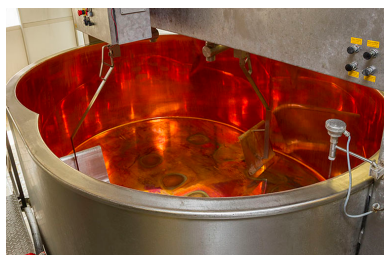
Cuve de fabrication double O. Phot. Yves Sancey IVR43_20132501470NUC2A
