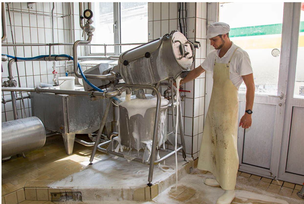
Nettoyage des installations : filtre à sérum.
