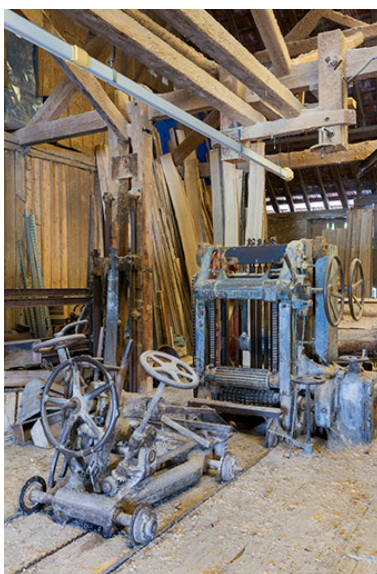
Châssis multilames et son chariot. Vue de trois quarts. Phot. Jérôme Mongreville IVR43_20162500436NUC4A
