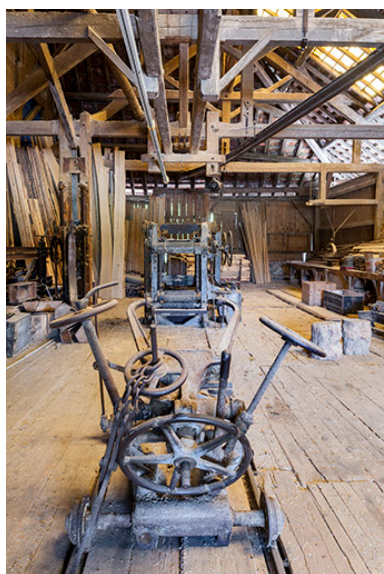
Châssis multilames et son chariot. Vue axiale. Phot. Jérôme Mongreville IVR43_20162500428NUC4A
