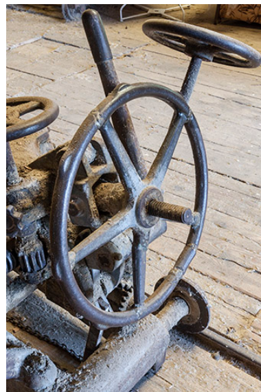
Volants du chariot du châssis. Phot. Jérôme Mongreville IVR43_20162500435NUC4A
