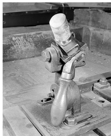
Fourneau enfoncé sur le culot amovible. Vue de trois quarts droite. Phot. Jérôme Mongreville IVR43_20022500576X
