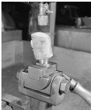
Détail du culot amovible présentant un fourneau dans l'axe de descente du poinçon. Phot. Jérôme Mongreville IVR43_20022500577X
