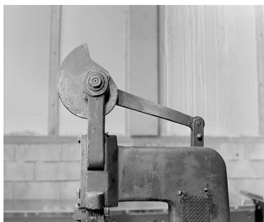
Vue de profil de la came. Phot. Jérôme Mongreville IVR43_20022500586X
