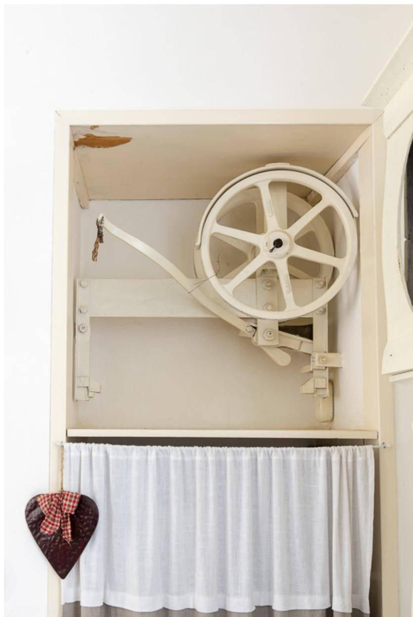
Mécanisme de monte-charge.
