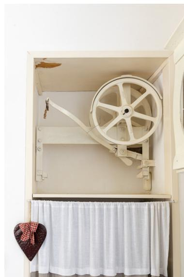
Mécanisme de monte-charge.
