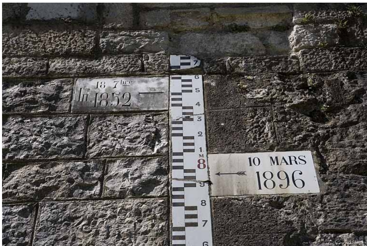
Partie supérieure de l'échelle limnimétrique, indiquant le niveau des crues de 1852 et 1896. Trois crues sont signalées : 10 mars 1896 (7,96 m), 18 septembre 1852 (8,50 m) et 21 janvier 1910 (9,57 m). La plaque de cette dernière manque.
