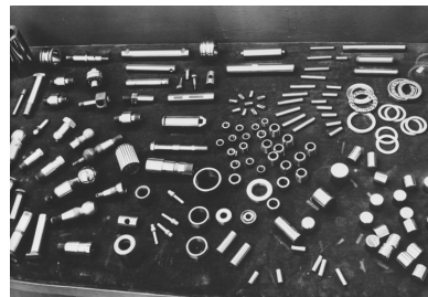
Pièces décollées. Phot. Raphaël Favereaux, Autr. NEPASUTILISERSabot (photographe) IVR43_20122501575NUC2
