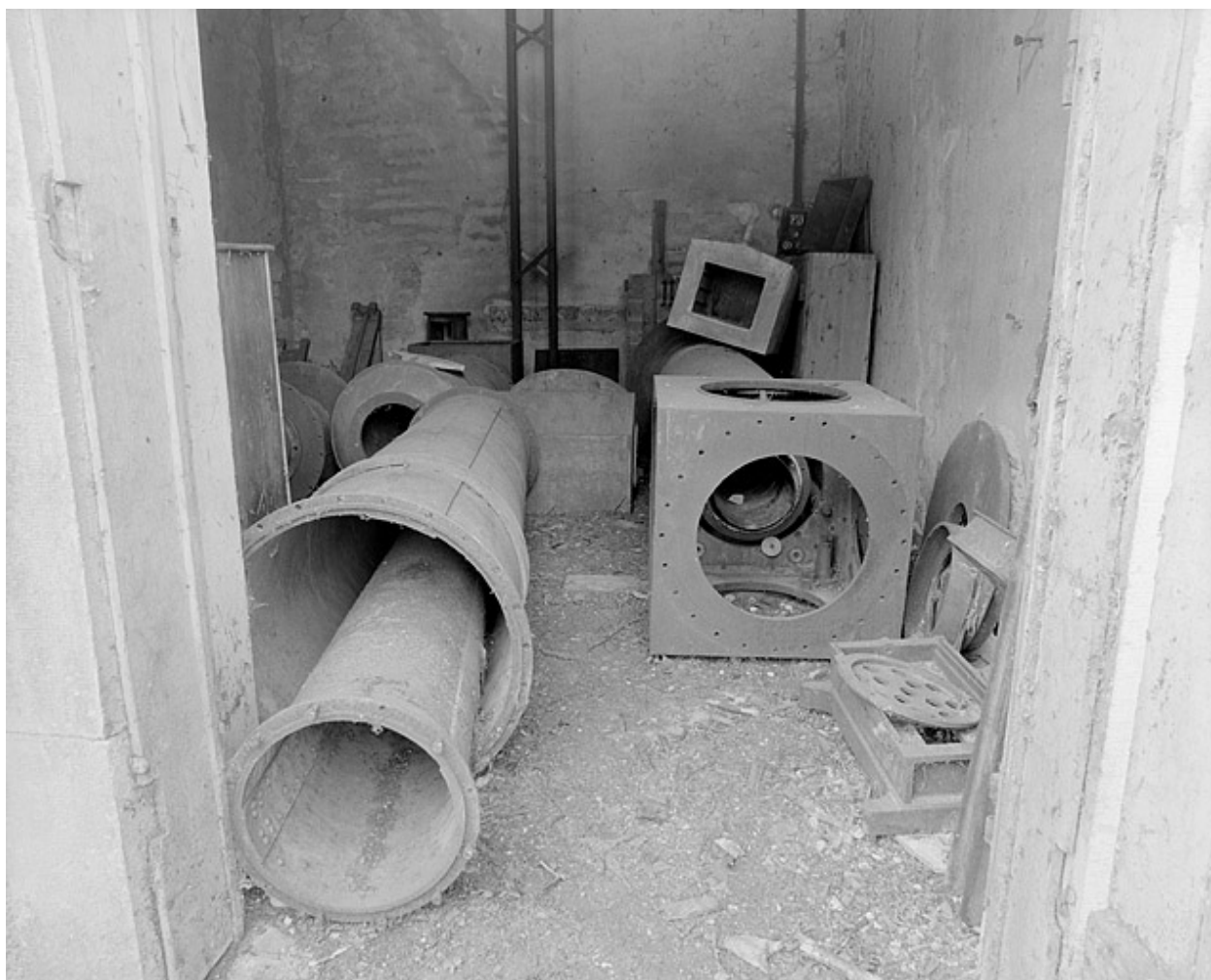
Tubes oculaires extérieur et intérieur, avec l'embase du pivot horaire inférieur et le cube central.
