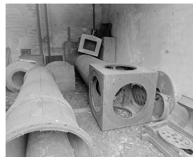
Tubes oculaires extérieur et intérieur, embase du pivot horaire inférieur, cube central et tube objectif. Phot. Jérôme Mongreville IVR43_20032501078X
