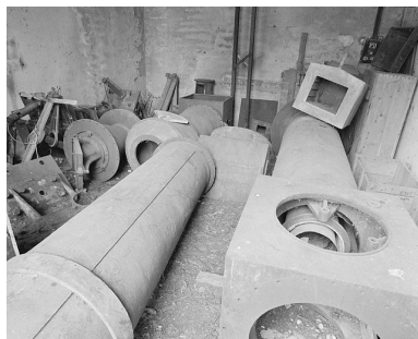
Tube oculaire, cube central et tube objectif - qui lui est toujours fixé - (au premier plan). Au fond, embase du pivot horaire supérieur, pivot horaire inférieur et son porte-miroir, ensemble contrepoids, cube objectif et embase du pivot horaire inférieur. Phot. Jérôme Mongreville IVR43_20032501081X
