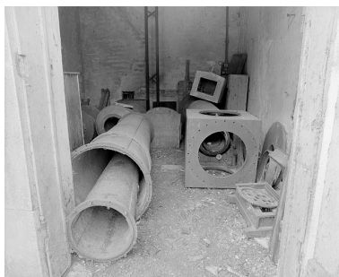
Tubes oculaires extérieur et intérieur, avec l'embase du pivot horaire inférieur et le cube central. Phot. Jérôme Mongreville IVR43_20032501080X
