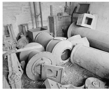
Pivot horaire inférieur et son porte-miroir, près de l'ensemble contrepoids (au centre). Cube objectif au fond près du mur, tube oculaire et tube objectif à droite. Phot. Jérôme Mongreville IVR43_20032501079X
