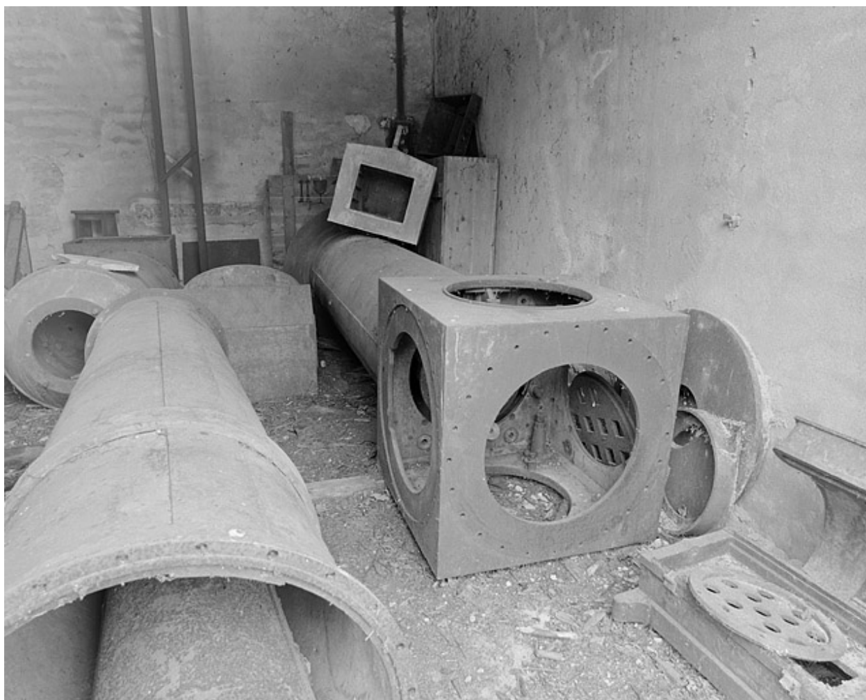
Tubes oculaires extérieur et intérieur, embase du pivot horaire inférieur, cube central et tube objectif.
