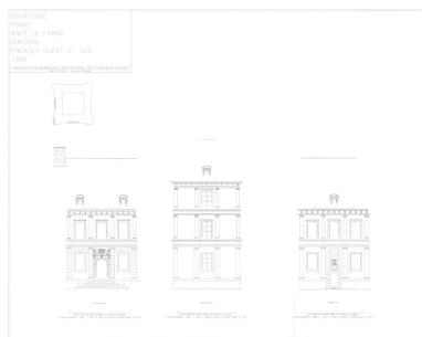
Façades ouest et sud, restitution photogrammétrique. IVR26_20128900002A1YY
