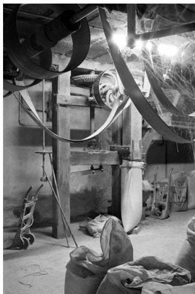
Minoterie (G), étage de soubassement : systèmes d'entraînement et d'allège d'une paire de meules.
