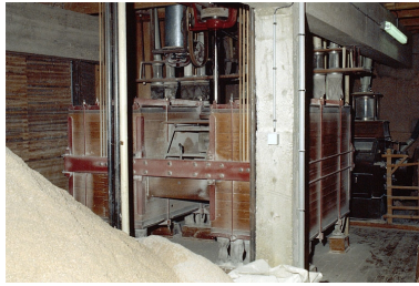
Minoterie (H), rez-de-chaussée : plansichter. Phot. Laurent Poupard IVR43_19883900524ZA
