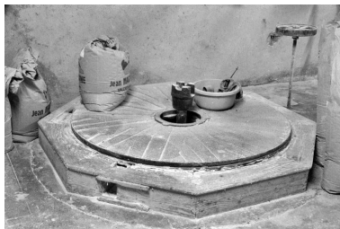
Minoterie (G), rez-de-chaussée : meule inférieure en cours de rhabillage. Phot. Laurent Poupard IVR43_19883900523Z
