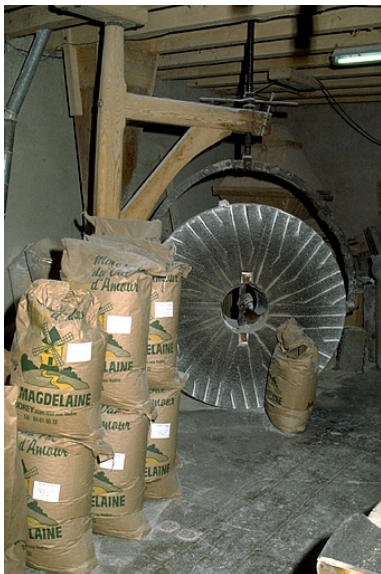
Minoterie (G), rez-de-chaussée : potence et meule. Phot. Laurent Poupard IVR43_19883900526ZA
