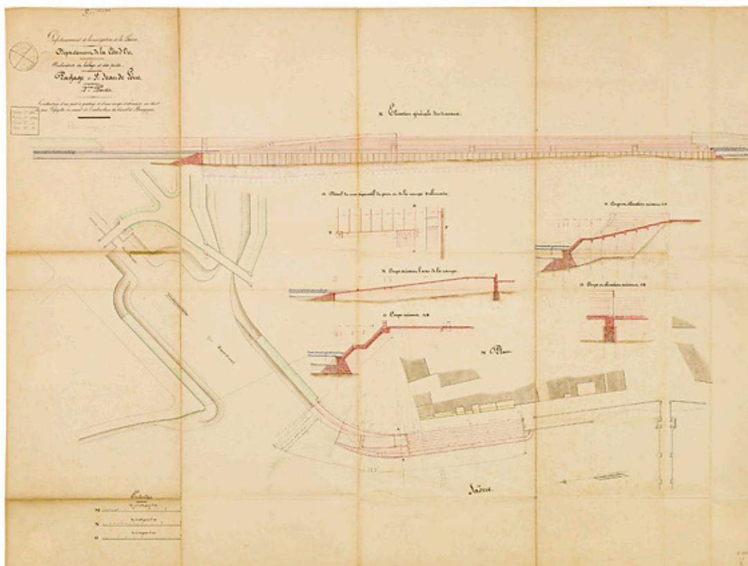
Construction d'un port à gradins et d'une rampe d'abreuvoir au droit du quai Lafayette en amont de l'embouchure du Canal de Bourgogne. Elévation, plan et coupe.
