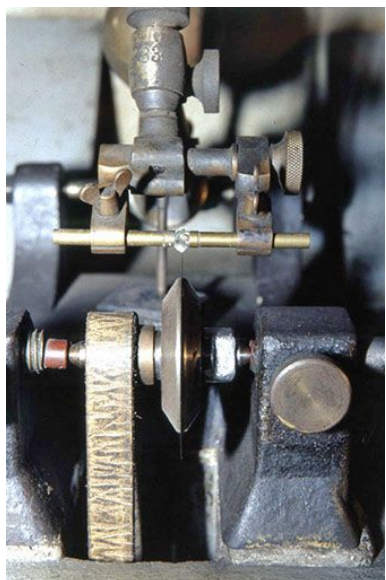
Molette (lame) d'une scie et diamant, vue de face. Pris entre deux mors, le diamant est au contact du disque en bronze phosphoreux, épais de 5 à 10 centièmes de mm. Phot. Jérôme Mongreville IVR43_20013900008ZA
