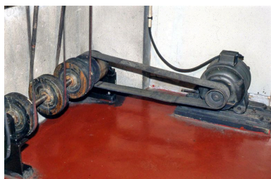
Moteur électrique Roulland et arbre de transmission. Phot. Jérôme Mongreville IVR43_20013900014ZA
