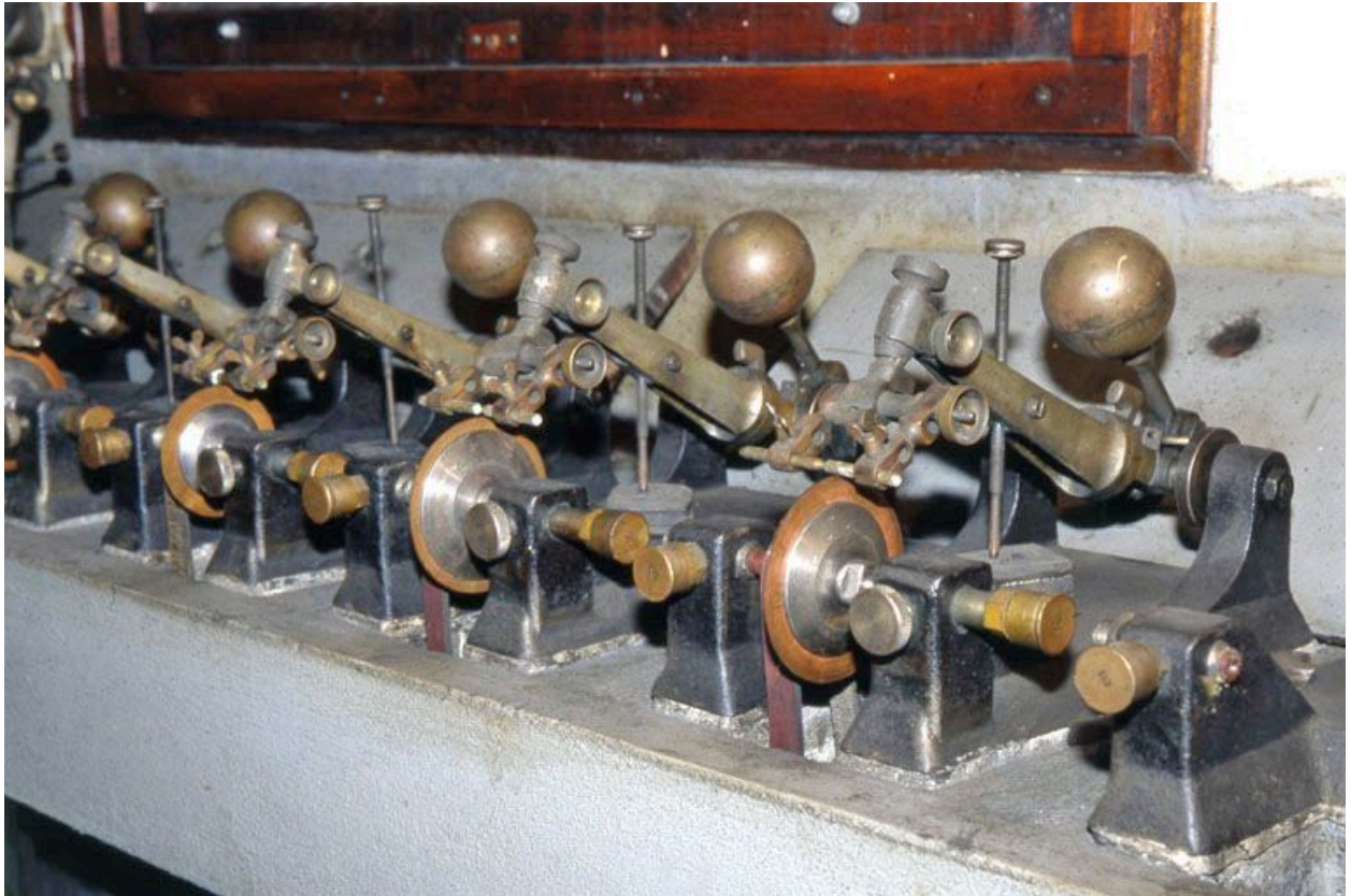
Ensemble de scies. Le contrepois sphérique et la tige filetée règlent la pression du diamant sur la lame circulaire.
