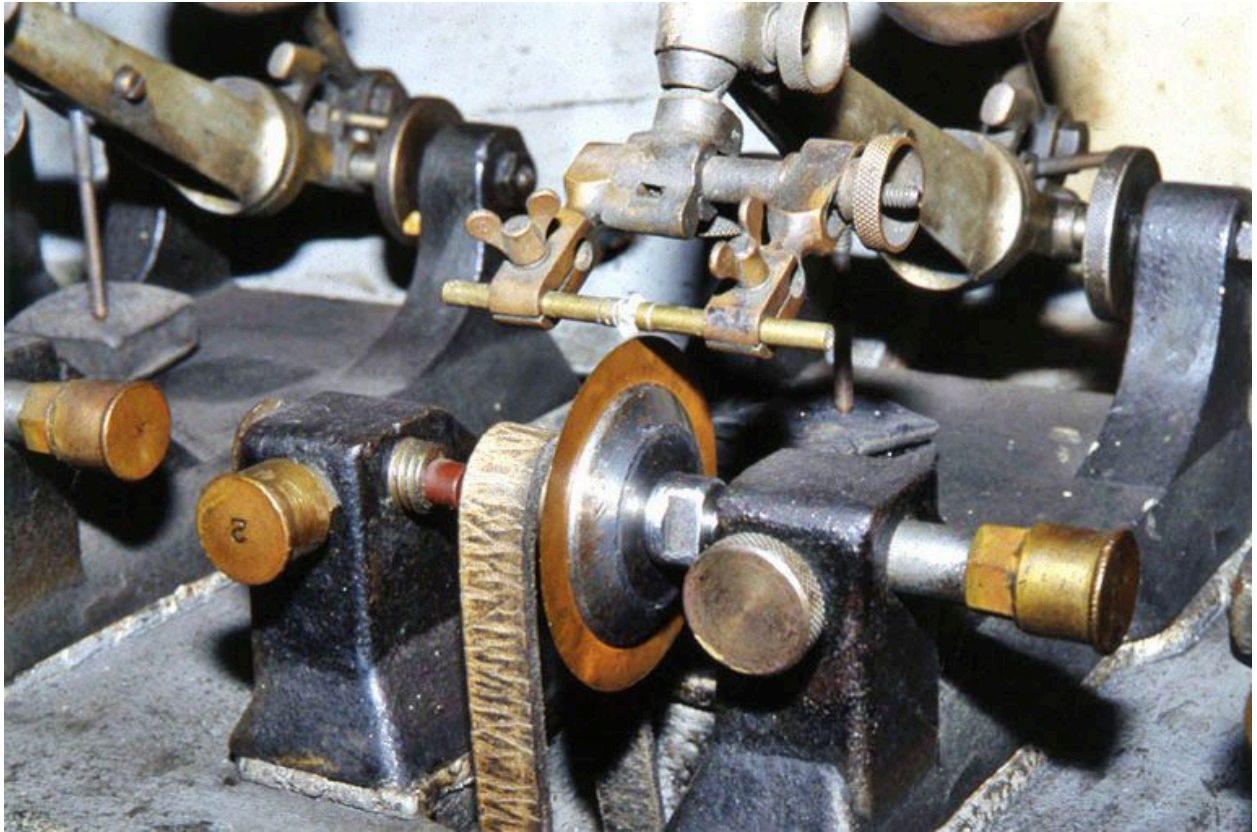
Scie vue de trois quarts. Pris entre deux mors, le diamant est au contact du disque en bronze phosphoreux.
