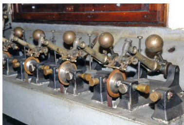
Ensemble de scies. Le contrepois sphérique et la tige filetée règlent la pression du diamant sur la lame circulaire. Phot. Jérôme Mongreville IVR43_20013900005ZA
