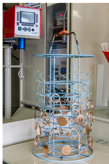
Usine : atelier de galvanoplastie (bouclard garni d'éléments de montre de gousset). Phot. Jérôme Mongreville IVR43_20142500305NUC4A
