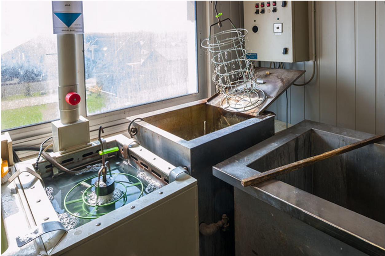
Usine : atelier de galvanoplastie (installations de nettoyage et égouttage).
