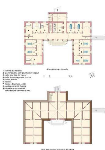
Plans schématiques du rez-de-chaussée et des combles.
