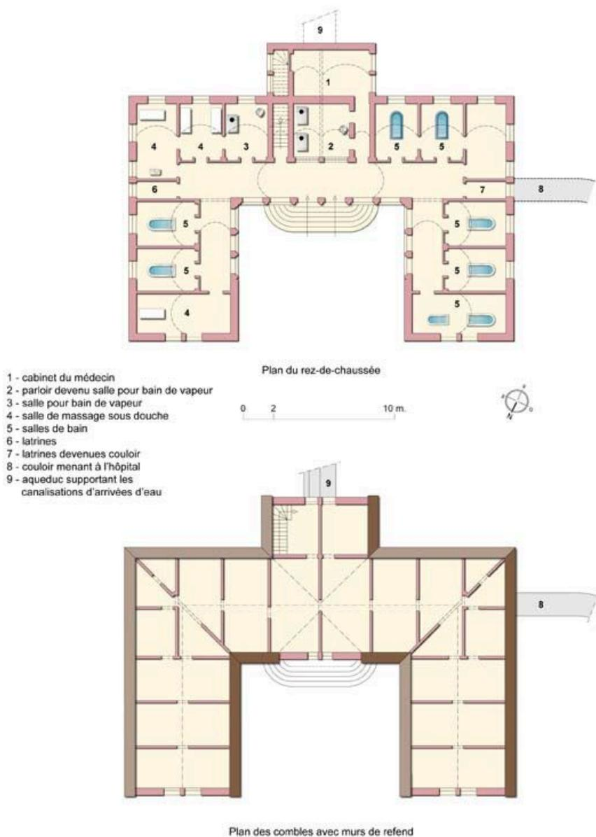
Plans schématiques du rez-de-chaussée et des combles.
