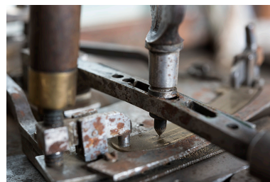
Module de gravage : la pointe à graver. Phot. Sonia Dourlot IVR43_20172500148NUC4A
