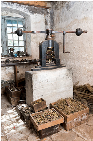
Vue d'ensemble (cadrage vertical). Les caisses au premier plan contiennent des pièces découpées (outils à centrer) et des déchets de découpe. Phot. Sonia Dourlot IVR43_20172500061NUC4A
