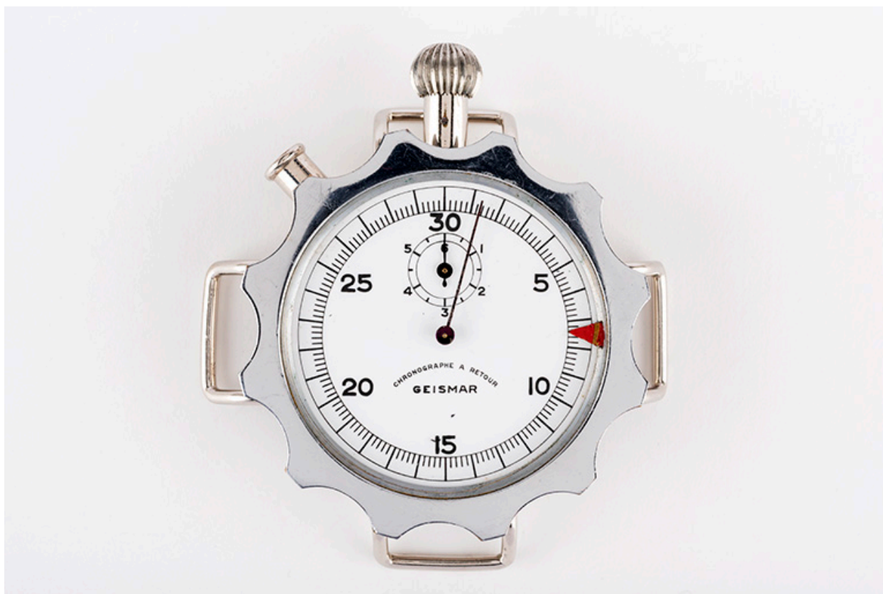
Chronographe à retour, 2e quart 20e siècle. (Collection musée du Temps, Besançon).
