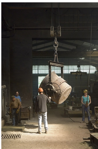
Préparation de la poche avant la coulée. Phot. Jérôme Mongreville IVR43_20067000489NUCA
