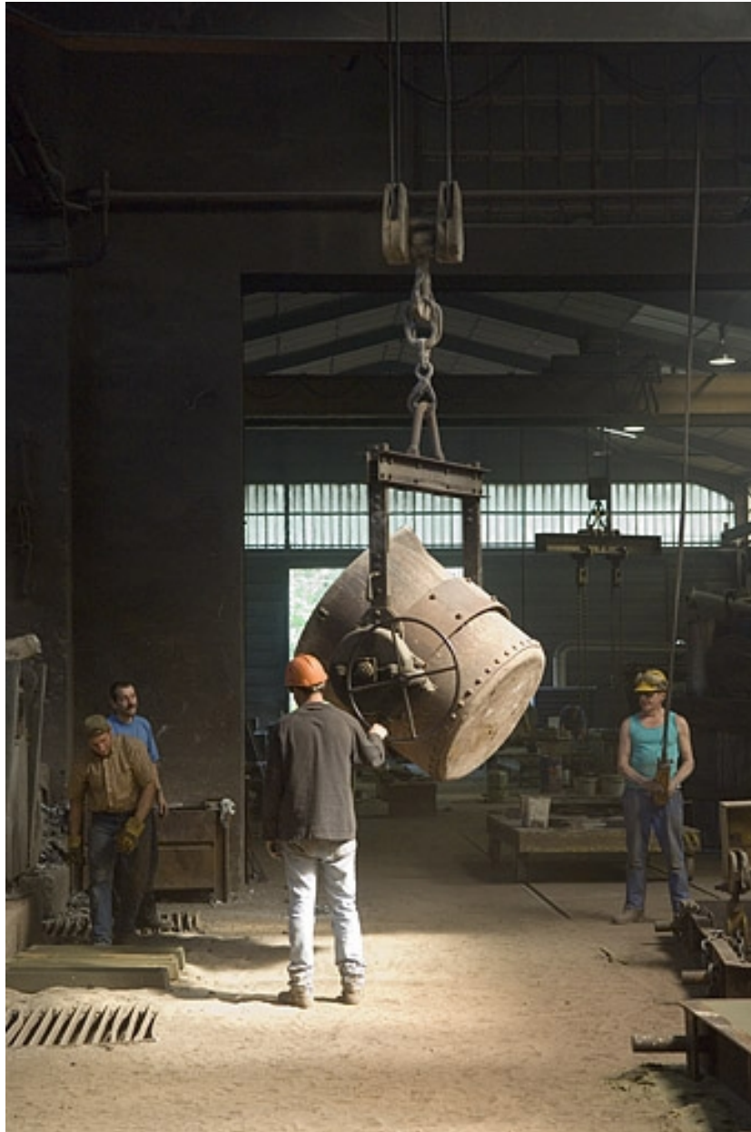
Préparation de la poche avant la coulée.
